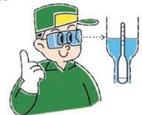
▼アドバイス：電解液比重測定時は、バッテリーの液量が液面線間の中間以上入っていること。液量が不足していると測定結果が高く出て、誤差が大きくなります。
