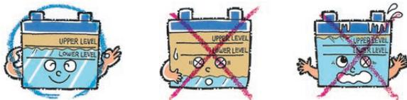
▼アドバイス：液口栓（キャップ）を開けた時は、補水後しっかりと締め付けてください。
