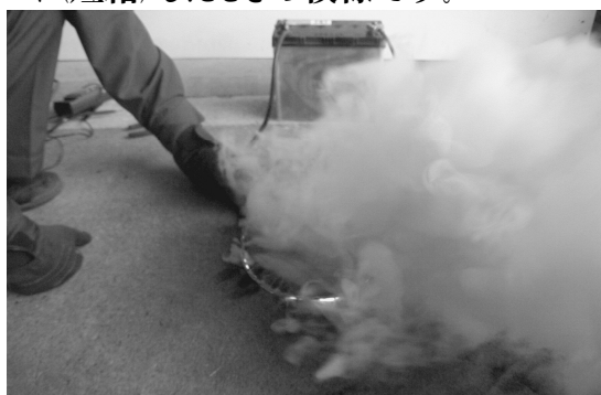
写真1 バッテリー端子間に電線を直接接続すると、電線が激しく発熱し被覆が燃焼する
