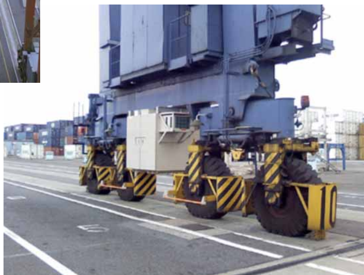
トランスファークレーン搭載用ハイブリッド電源装置：住友重機械 エンジニアリングサービス株式会社殿ご提供
